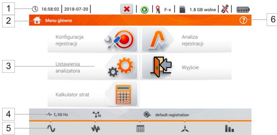
Rys. 5.2 Główne elementy ekranu rejestratora
